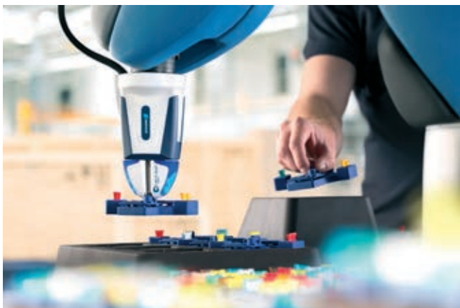
» Robot COMAU Racer5 prilagaja ohišja z električnim vezjem z uporabo SC-HUNKOVEGA prijemala Co-act EGP. Robot preda popolnoma sestavljene module zaposlenemu delavcu, ki privija vijake in pregleduje kakovost modulov.
