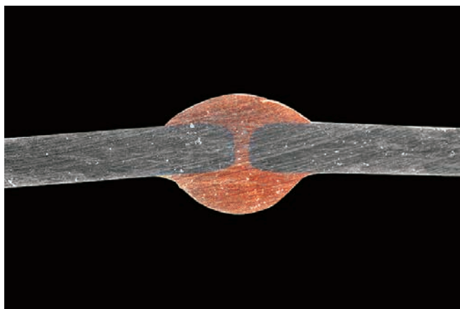
» Slika 1. Nova LSC značajka dubokog protaljivanja koju je razvio Fronius idealna je za zavarivanje korijenskog sloja, kutnog spoja, ugaonog spoja, preklopnih spojeva kao i za slojeve popune, završne spojeve i lemljenje. Prikazano na slici: sučeljeno zalemljeni spoj primjenom funkcije LSC Braze (debljina materijala: 1,0 mm; pocinčano; dodatni materijal: CuSi 2 ; promjer žice: 1,0 mm)
