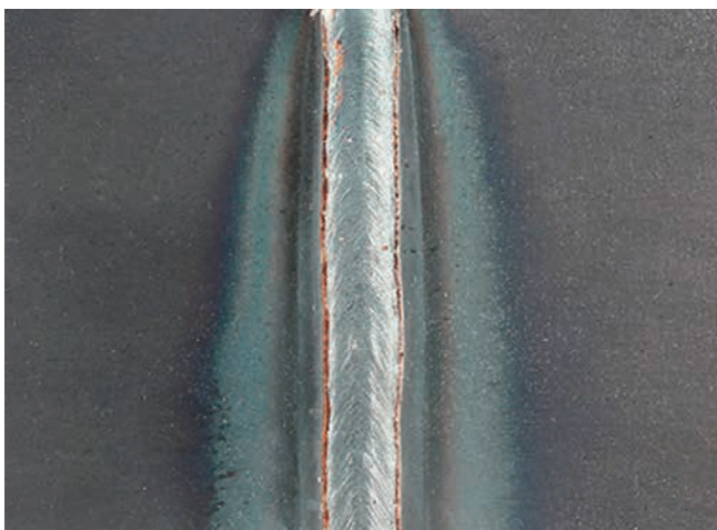
» Slika 7. Funkcija „LSC Root“ savršena je za zavarivanje sučeonih spojeva (na slici: sučeonih spoj izveden LSC Root; promjer žice: 3 mm; PA)
