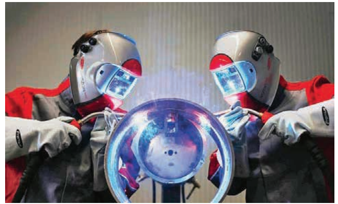
» Slika 4. Zajednički rad - istodobno zavarivanje korijenskog sloja na obje strane cijevi korištenjem funkcije „LSC Root“
