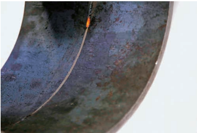
» Slika 3. Zavar učinjen primjenom funkcije „LSC Universal Advanced“ u zaštiti mješavine argon/ CO 2 (promjer žice 1,2 mm)
