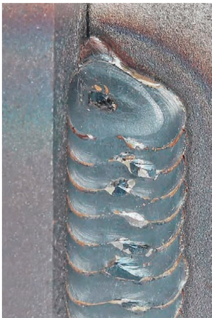
» Slika 6. Zavarivanje vertikalno prema gore primjenom funkcije „LSC Universal“ i aktiviranog stabilizatora protaljivanja (promjer žice 1,2 mm)
