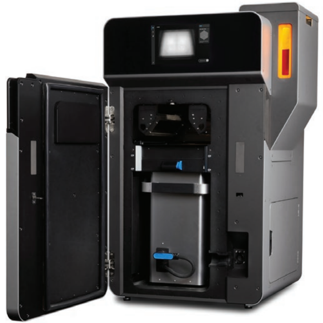
» Slika 3: Pisac Fuse 1 s komorom za ispis u unutrašnjosti i spremnikom praha na gornjoj desnoj strani
