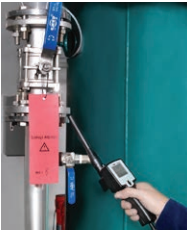
» Slika 3: Meritve puščanja stisnjenega zraka
