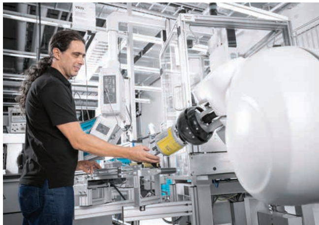
» Prilagodljivi i suradnički robot radi pri sastavljanju ventila u izravnoj i sigurnoj interakciji sa zaposlenicima. (Foto: Festo AG & Co. KG)
