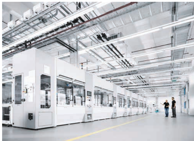
» Potpuno automatizirana i modularno izgrađena montažna linija s osam proizvodnih čelija ima duljinu približno 30 metara, a godišnje izrađuje i sastavi više od milijun ventila VUVG. (foto: Festo AG & Co. KG)
