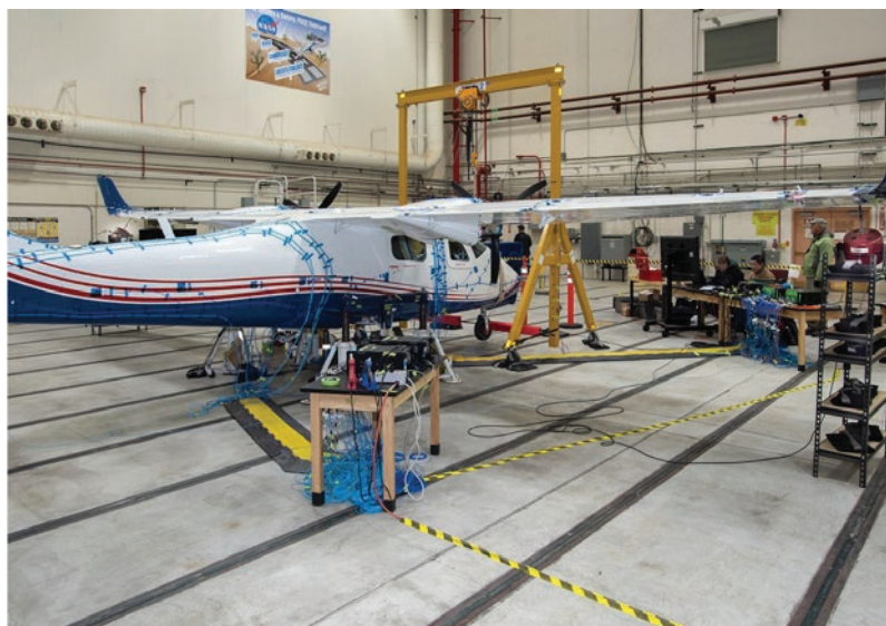
» Testovi vibracija su se pokazali kao važna prekretnica pri razvoju nove letjelice X-57 "Maxwell". | Izvor: Hottinger Brüel & Kjær
