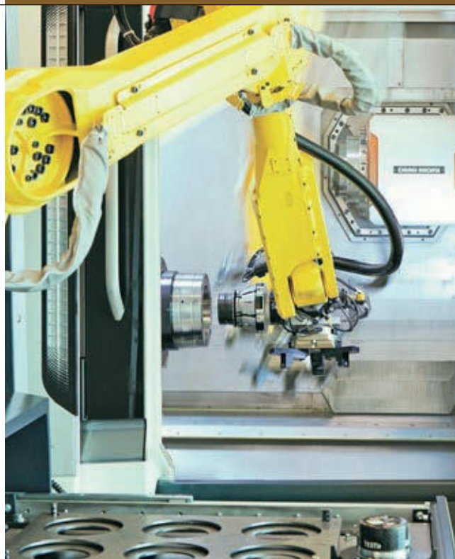
» Trend v smeri avtomatizacije: z robotom lahko avtomatizirate zamudno zamenjavo vpenjalne glave in prislonov (slika: Hainbuch)
