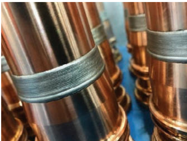
» Lasersko varjenje omogoča uporabo širokega razpona materialov, kot na primer varjenje nerjavnega jekla ASTM 420 na berilijev baker | Vir: Phoenix Laser Solutions
