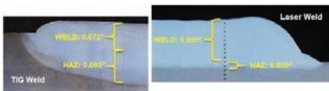
» Lasersko varjenje je veliko bolj natančno in povzroča bistveno manjše toplotno prizadeto področje v primerjavi z varjenjem po postopku TIG. | Vir: Alpha Laser
