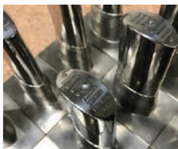
» Jedra orodja za brizganje plastike popravljena s postopkom laserskega varjenja. | Vir: Phoenix Laser Solutions
