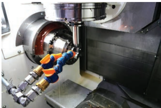
» Glavno vreteno ima ugrađen motor, koji se okreće frekvencijom 5000 okr/min.
