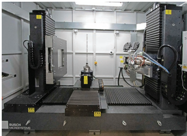
» Notranost visoko natančnega sistema CT z granitnim manipulatorjem. | Vir: VisiConsult
