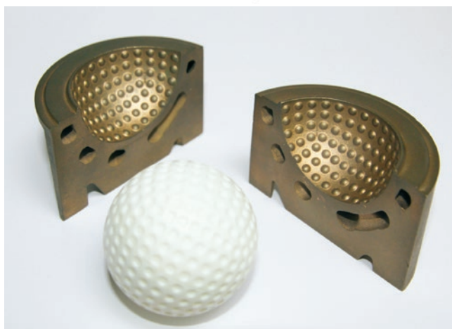
» Slika 4. Kalup za puhanje s prikazanim kanalima za temperiranje i kanalima za odzračivanje kalupne šupljine. | Izvor: Es-Tec, DemoCenter
