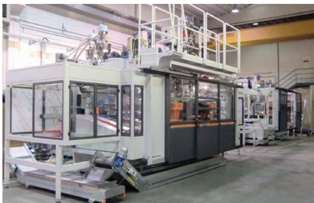
» Plastiblow električna puhalica s dvije stanice model PB10E/DXL koekstrudira 2 sloja za proizvodnju Castrol GTX 5 litrenih kanistara s dvostrukom ručkom i prozirnom trakom opremljen s pomoću kalupa s 2 kalupne šupljine.
