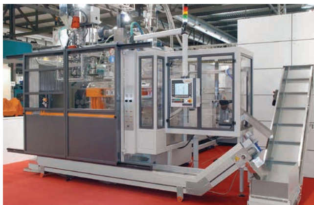
» Plastiblow električna puhalica s jednom stanicom model PB10E/SXL za proizvodnju 5 litarskih kanistara s pomoću kalupa s 3 kalupne šupljine.
