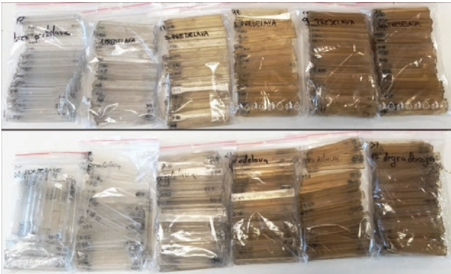
» Slika 2: Injekcijski prešane epruvete za karakterizaciju linearnog PC (gore) i razgranatog PC (dole)
