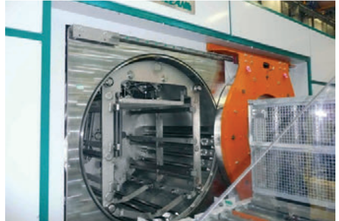
» Pogled v komoro: Vstopna vrata komore, kamor se vstavi cela paleta delov (gitterbox).
