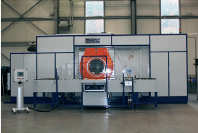
» Večja naprava Multiclean S4-PRO: Naprava omogoča pranje večje količine delov v t. i. gitterbox paletah.
