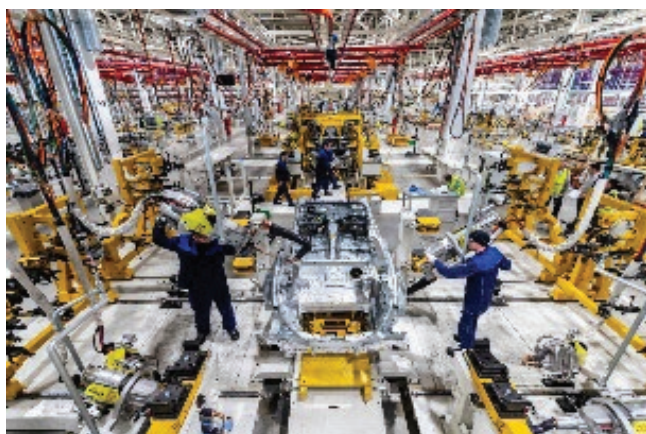
» NIMAK ročni varilni gorilniki v proizvodnji v novi montažni tovarni Mercedes-Benz v Rusiji.
