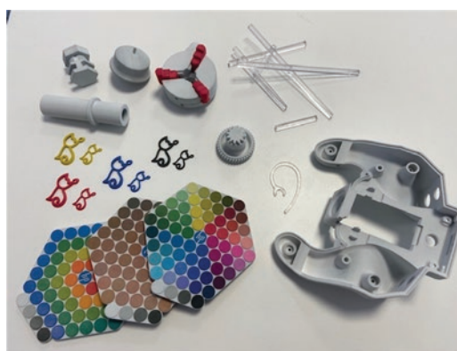
» Slika 3. HP MJF u PCS-u: a) HP Jet Fusion 580 Color 3D Printer, b) primjer MJF proizvoda (mogućnost ispisa u boji)
