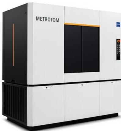
Na temelju rezultata CT mjerjenja u Topomatici mogu vrlo precizno digitalizirati uzorke, uključujući unutarnje geometrije na razini najfinijih detalja, a po potrebi i provesti daljnje analize (poroznost, GD&T). To je posebno važno u industriji, znanosti, istraživanju i razvoju. Svakim danom se sve više i više grana tehnologije okreće budućnosti i koristi CT mjerjenje za vrhunske rezultate.
