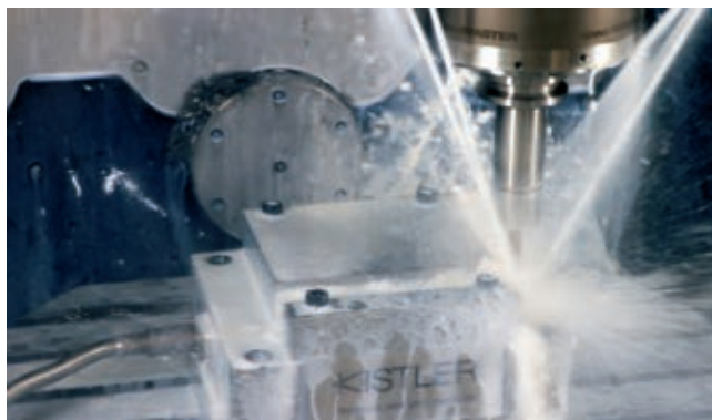
» V podjetju Big Kaiser so uporabili merilni sistem podjetja Kistler za merjenje sil odrezavanja in na podlagi rezultatov vrednotili zmogljivost vpenjalne glave MEGA New Baby Chuck v primerjavi s konkurenčnimi izdelki. Vir: Big Kaiser
