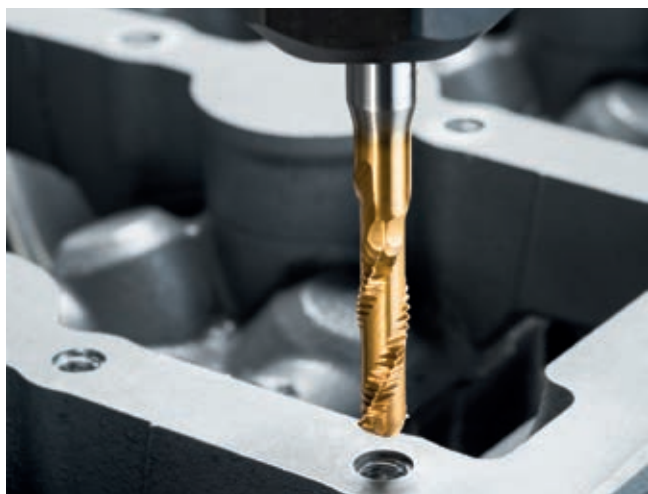
» Tehnologija izdelave navojev Punch Tap podjetja Emuge omogoča ohranjanje virov pri masovni proizvodnji, saj omogoča do 75-odstotne časovne prihranke in je namenjena obdelavi z uporabo minimalne količine hladilno-mazalnega sredstva. Vir: Emuge-Franken
