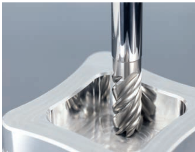
» Podjetje Emuge z lastno patentirano geometrijo odrezavanja Cut&Form med končno obdelavo s svojimi frezali zagotavlja izdelavo poliranih površin s hrapavostjo med N1 do N3. Vir: Emuge-Franken
