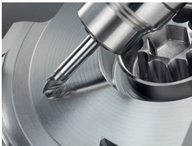
» S svojimi velikimi radiji v področju odrezavanja ponujajo krožna segmentna frezala podjetja Emuge bistvene prednosti na področju kakovosti obdelane površine in časa obdelave. Vir: Emuge-Franken
