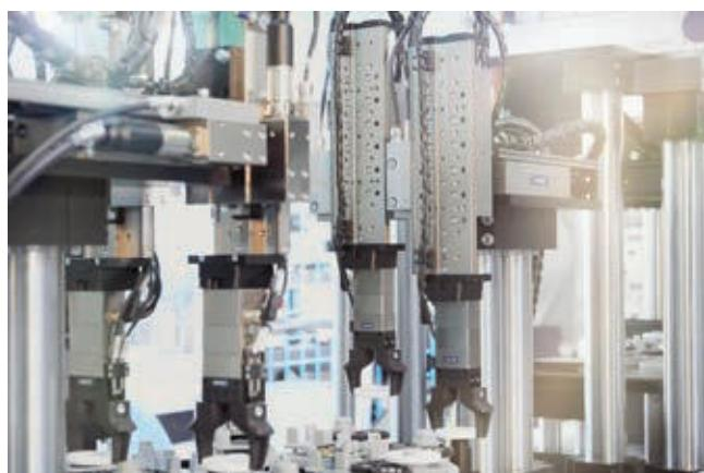
» Taj pametni sustav za automatizaciju montaže omogućuje vrlo prilagođive procese. Module je pored toga moguće bilo kada mijenjati s pomoću standardiziranih sučelja. Slika: SCHUNK
