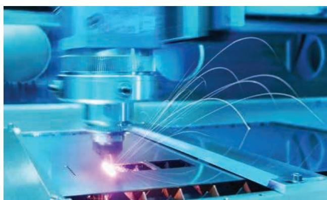
je zanimalo više od optimiranja diodnih lasera velikih snaga, postizanje procesa visokopreciznog laserskog rezanja. Konstruktori su postigli poboljšanja komponenata, i najvažnije, da u sustavu za oblik zrake za kilovatne (kW) izvore, primijene prilagođene optičke, mehaničke i toplinske modifikacije.
