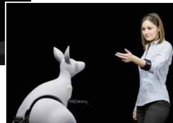
» Tako kot naravni vzornik lahko tudi bionični kenguru pridobi, shrani in ponovno uporabi del energije prejšnjega skoka pri naslednjem. Vodimo ga lahko tudi samo s kretnjami. (Foto: Festo AG & Co. KG)
