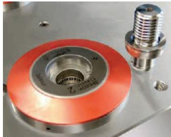
kao sustav s nultom točkom i tako možemo obradak primjenjivati preko više strojeva ili za povremena mjerena.
