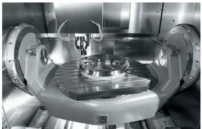
» Veliki radni prostor obradnog centra C 42 U s okretno/nagibnim numerički upravljanim stolom dimenzija 800 x 630 mm (osi A i C) za petosnu/petostranu kompletну i simultanu obradu najrazličitijih komponenata akceleratora čestica.
