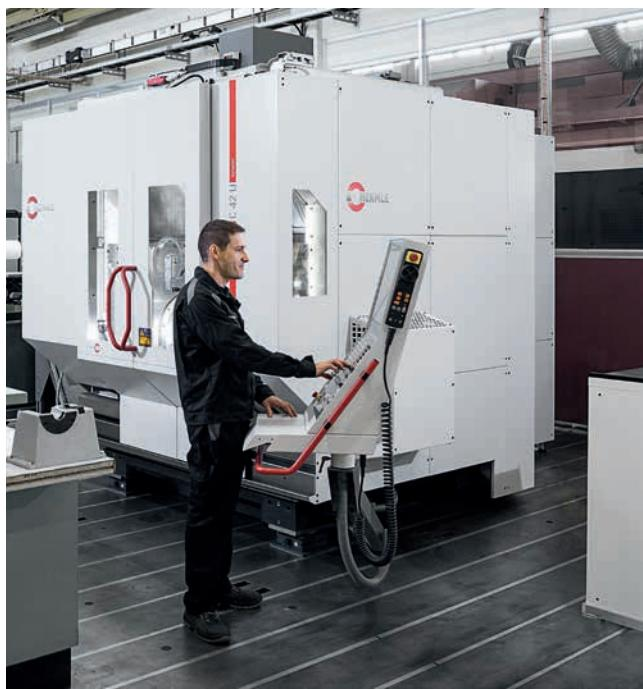
» Petosni visokoučinkoviti CNC-obradni centar C 42 U dynamic u CERN-ovom odjelu MME opremljen je s paketima točnosti I i II za visokotočnu i ponovljivu kvalitetnu obradu unutar područja  $\pm 0,5 \mu\text{m}$ .
